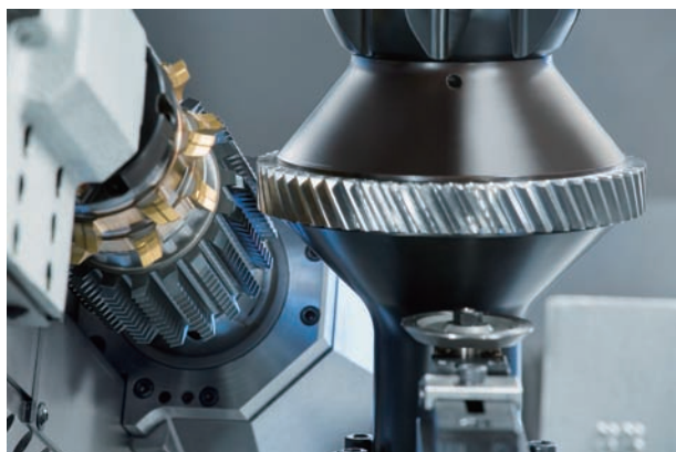
VL 4 H机床专为最大直径 200 mm、模数为 4 的齿轮类工件而设计
