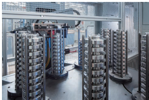
TrackMotion自动化系统中可使用堆垛机托盘，在上面可以堆垛存放大量毛坯件
