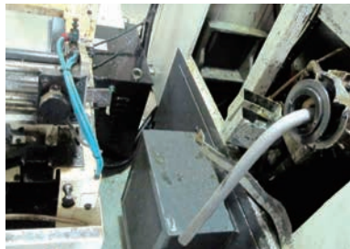
图2 棒料超长引发的事故现场
