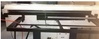
图3 送料机安装限长杆
