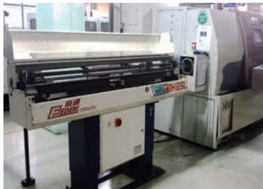
图1 自动送料机和数控车床的布局
