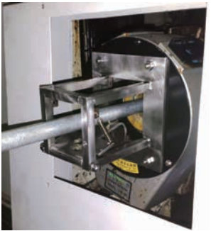
(b) 顶料杆顺利通过 图6 防错装置的工作情况
