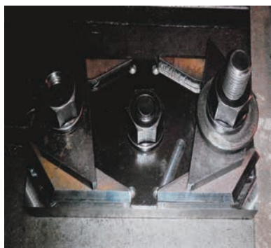
图7 采用一次加工工装加工示意图
