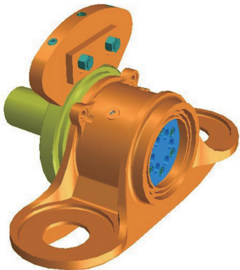
图6 轴箱体迷宫槽加工工装三维效果图
