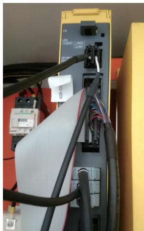
图13 补偿模块与I/O单元的连接
