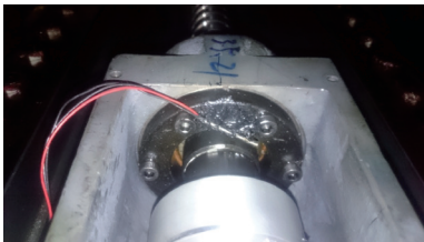
图2 PT温度传感器安装于主端轴承座
