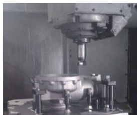
图6 减压器II型壳体加工示意图
