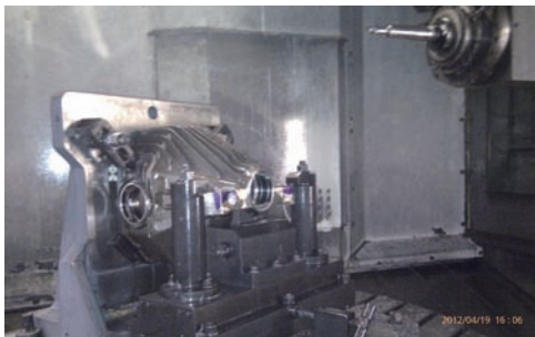
图5 减压器I型壳体加工示意图
