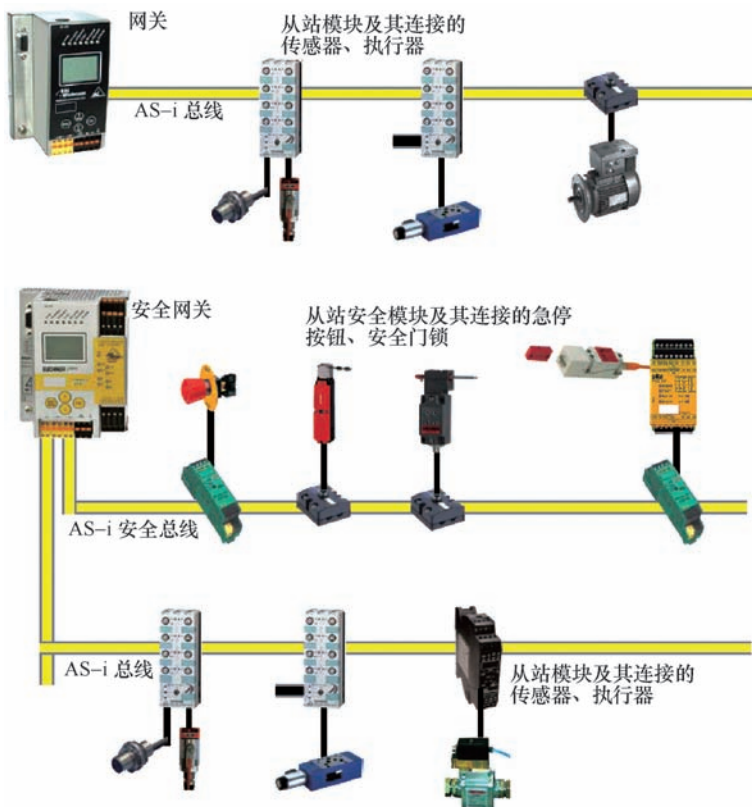
图1 GROB机床AS-i总线网络拓扑图
