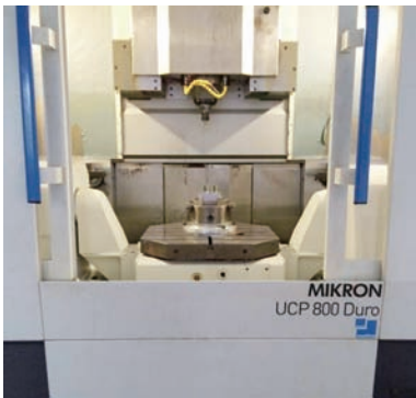
图7 整体叶盘基准件精加工装夹图
