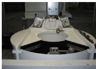
图9 连杆大头孔激光造型设备
