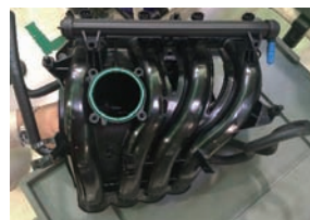
图2 PP+GF35 改性复合材料进气歧管
