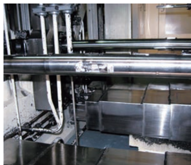
图3 双工位组合机床（前镗杆为半精镗杆，内带有油缸径向进给左右双刀镗曲轴止推面，后面为精镗杆）
