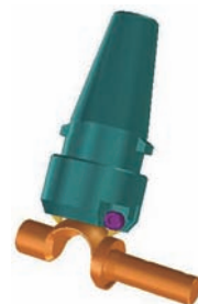
图4 旋风铣加工球面三维立体效果图
