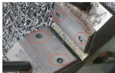
图5 清除工装轴颈贴合面螺栓孔杂物
