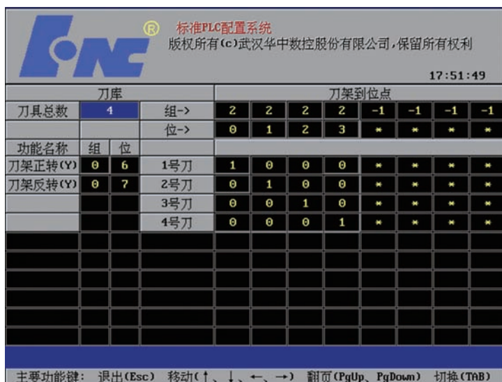
图9 刀架信号配置画面（初始配置）
