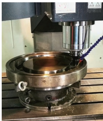
图3 数控铣床加工铸铝模
