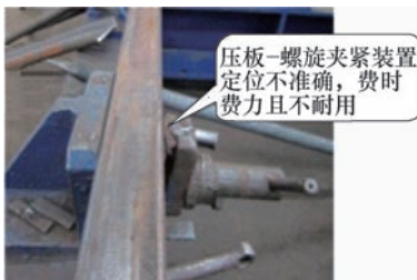
(b) “压板—螺旋”（夹紧状态）
