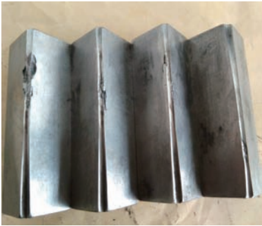
图1 损坏后的旋锻模具实物
