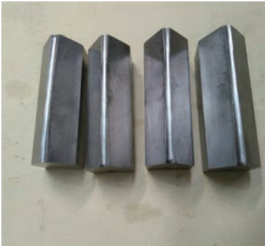
图4 修复后的旋锻模具实物
