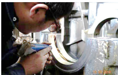
图7 机体主轴承孔微弧火花焊修
