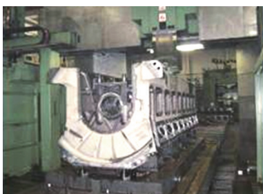
图9 焊修后机体加工中
