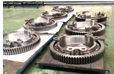
图11 置换修复后的从动齿轮
