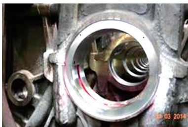
图10 焊修与加工后的机体主轴承孔
