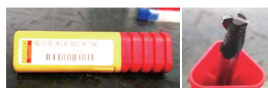
(a) (b) 图1 立铣刀标牌型号三刃波刃立铣刀
