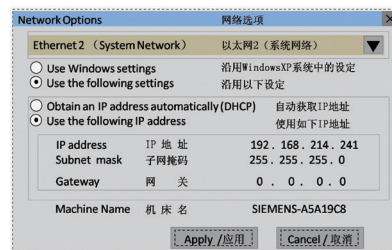
图6 C50切齿机上备份/还原用网络参数的设定
