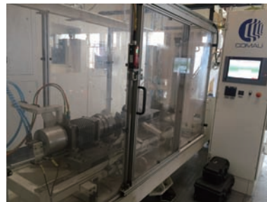
图1 曲轴质量中心测量机
