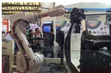
(a) 机器人集成的360°智能在线测量
