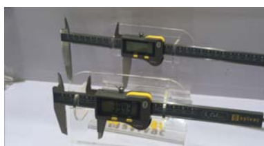
(a) 配置蓝牙传输装置的卡尺
