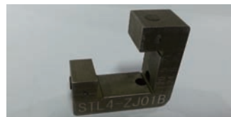
图3 检具止规可选设计
