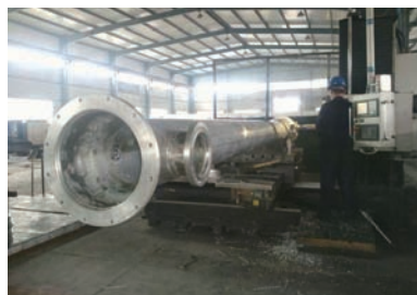
图2 带有两个侧法兰的大型壳体镗削
