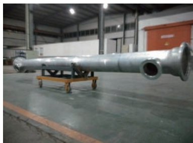
图1 带有两个侧法兰的大型高压开关壳体
