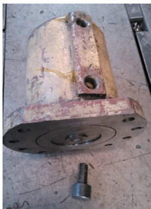
图3 损坏的液压缸
