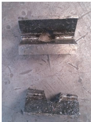
图4 断裂的承压块
