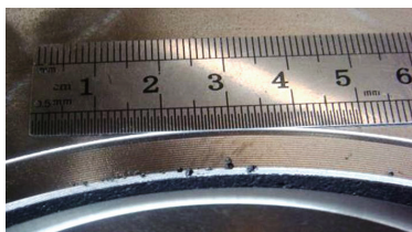
图2 加工后暴露出的A、B部位气孔
