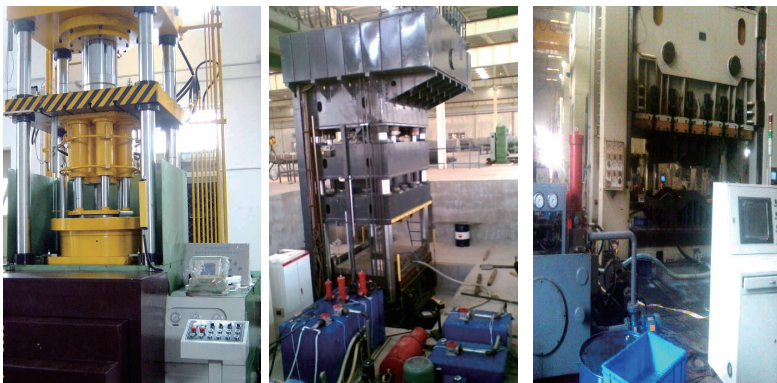
图5 550t、1050t和1600t国产板形件充液成形液压机
