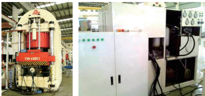
图7 10000t管材充液成形机及其所配置的超高压源
