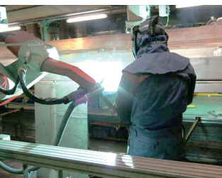
图11 车体组焊机器人焊接
