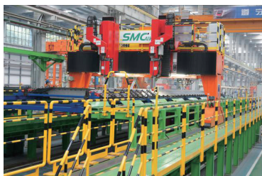
(a) 底架电阻焊示意
