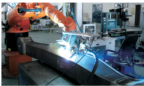
图17 激光-电弧复合焊接技术
