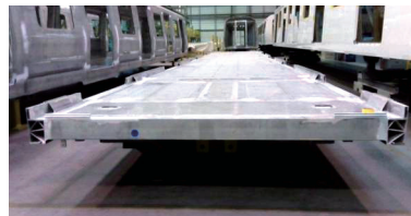
图3 底架组焊结构示意
