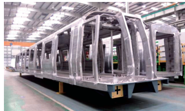
图1 铝合金车体结构示意
