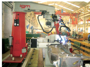
图15 C型悬臂旋转式+直线导轨
