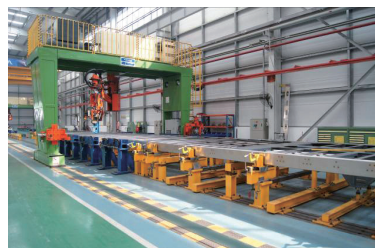
(b) 顶盖电阻焊示意
