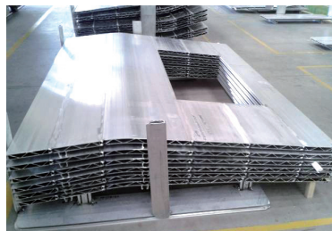
图9 侧墙板结构示意图
