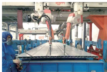
图8 地板组焊机器人焊接
