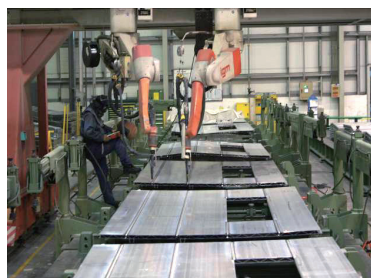
图10 侧墙板组焊机器人焊接
