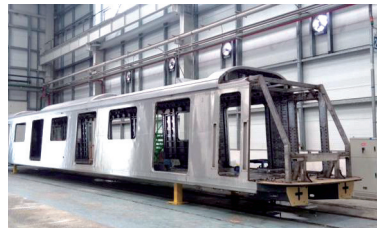
图2 不锈钢车体结构示意
