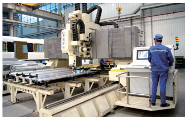
(a) FSW产品焊接示意
