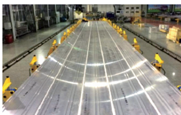
(b) FSW地板焊接示意
