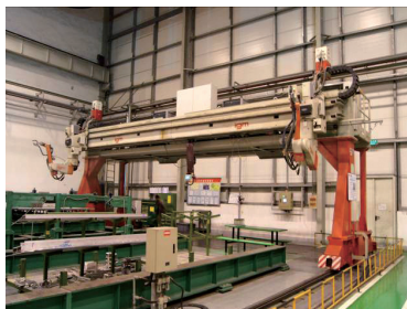
图14 龙门式焊接机器人
