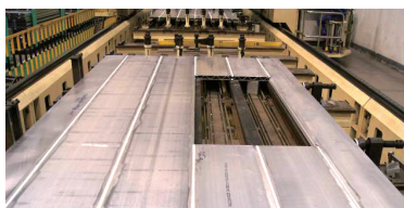
(d) FSW侧墙焊接示意
