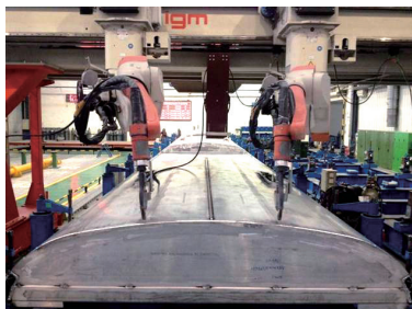
图6 顶盖组焊机器人焊接
