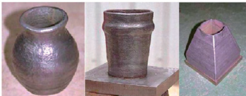
图6 机器人GMAW快速成形制造系统的成形件
