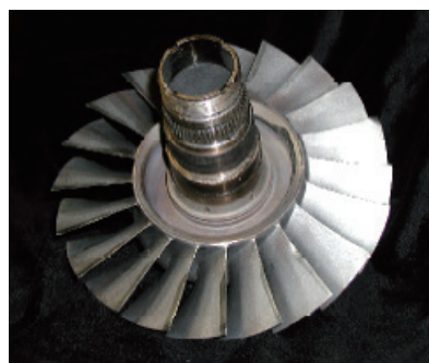
图4 采用LENS技术修复的整体叶盘
