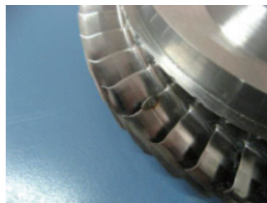
图9 激光成形修复叶轮和叶盘
