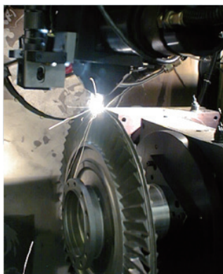
图3 采用LENS技术修复的发动机叶片
