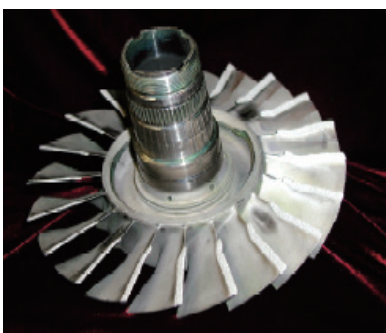
图4 采用LENS技术修复的整体叶盘
