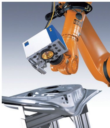
图2 遥控激光焊在车体制造中的应用
