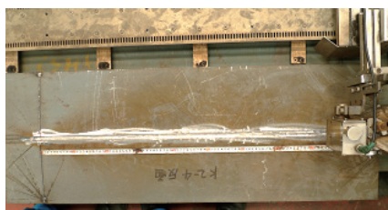
图4 碳刨机及碳刨面光顺和直线度
