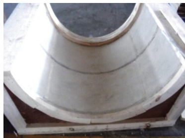
图5 定型阶段菱苦土模样
