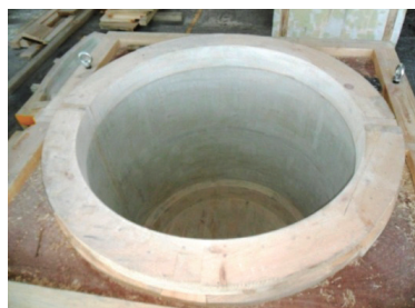
图6 制作完成后的菱苦土模样
