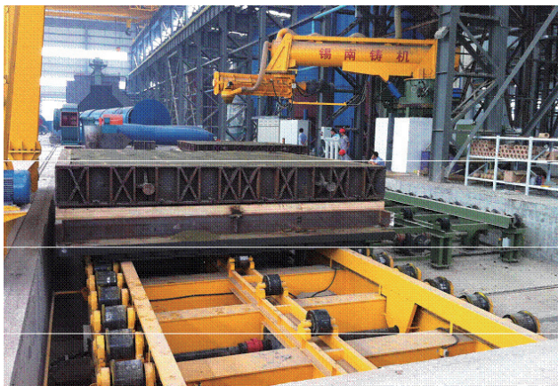
图2 德哈克风电6.5m×7m大型震实台
