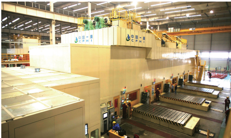
图1 伺服压力机和机械压力机混合冲压生产线
