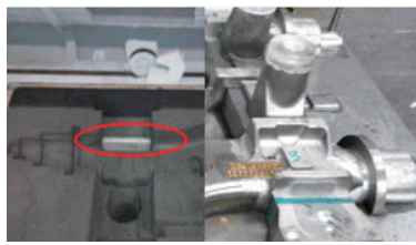
图7 加高冒口及配合冷铁
