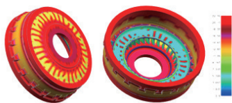
图2 铸件壁厚分布
