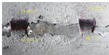
(a) R111.4 辊身开裂处硬度检测
