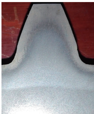
图4 渗碳加感应淬火硬化层分布
