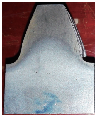
图3 整体感应淬火后硬化层分布情况 (齿顶硬化层过深11mm、齿沟硬化层1mm)
