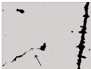
图7 开裂下模板裂纹图（50×）
