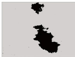
图6 开裂下模板DS夹杂物图（100×）
