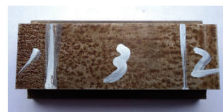
图2 开裂下模板取样图
