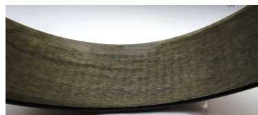
图1 滚道酸洗后烧伤图片
