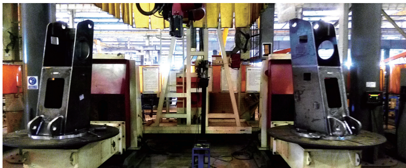
图1 机器人焊接工位布置
