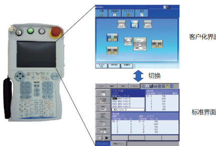
图6 Motoplus的传感控制示例
