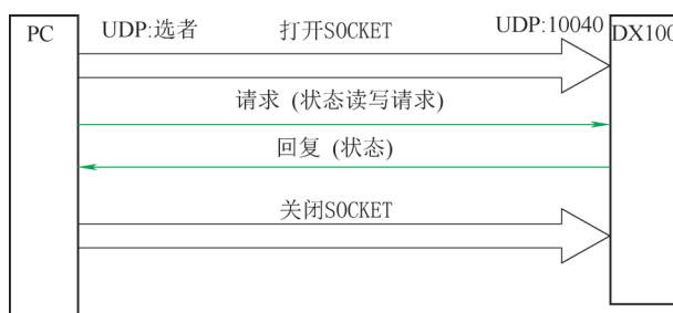
图1 机器人控制/状态读取流程
