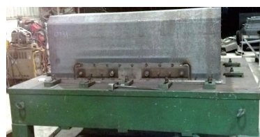
图8 工装夹紧焊接
