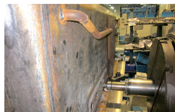
图2 油箱焊后在数控机床上加工密封面
