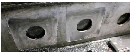
图3 机加工后的密封面
