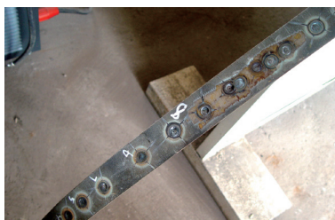
图3 组装间隙对TIG点焊影响情况
