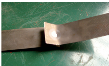
图1 经扁铲剔,点焊缝未撕开
