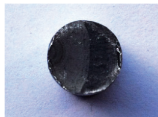
图2 螺栓失效断口（实物）
