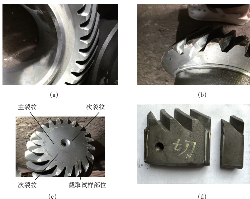
图1 弧齿锥齿轮裂纹形貌
