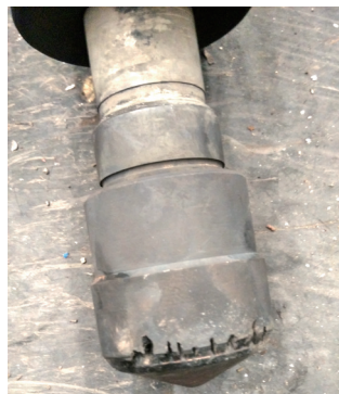
图1 失效的阀头形貌
