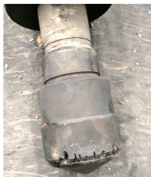
图1 失效的阀头形貌
