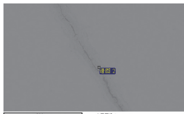
(a) 裂纹处能谱激发位置
