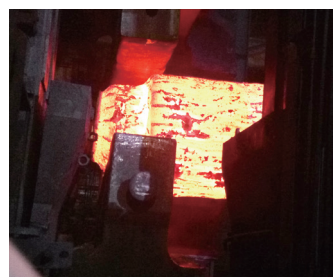
图6 850mm上平下V形砧端部下料
